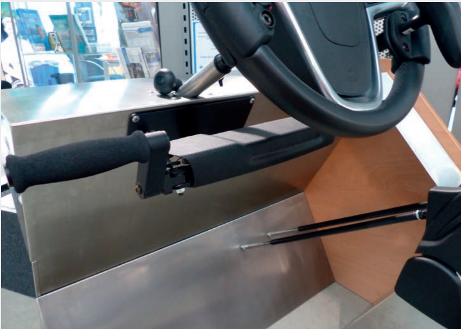
Handbediengerät Handbediengerät quer unter dem Lenkrad in verschiedenen Ausführungen, z. B.: Zug/Druck, Kipp oder Schwenkbewegung
