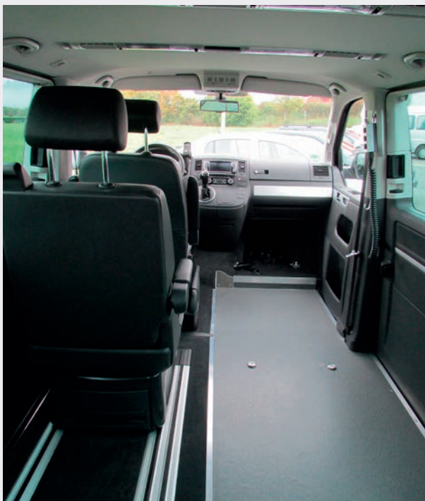
Bodenbegradigung EINE Seite (Fahrer oder Beifahrer)
