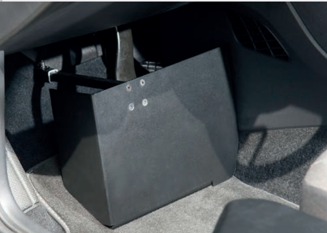
Pedalsperre steckbar, einfachste Handhabung
