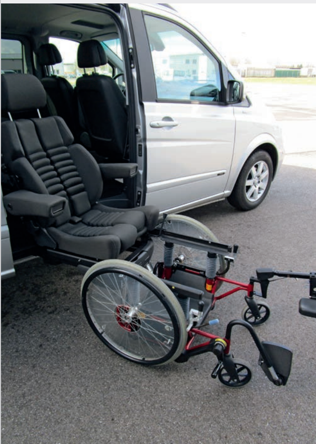
Turny Evo / Auto Adapt mit orthopädischem Sitz & Carony Rollstuhluntergestell
