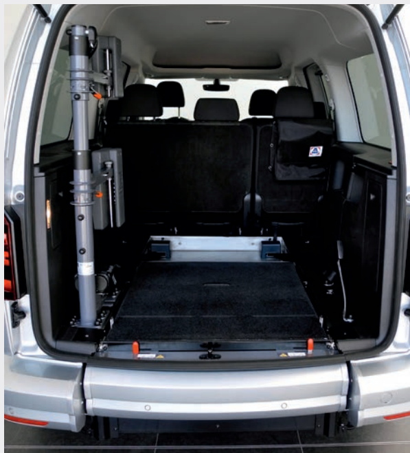
VW Caddy 4 mit umklappbarer Rampe, sodass ein ebener Boden entsteht
