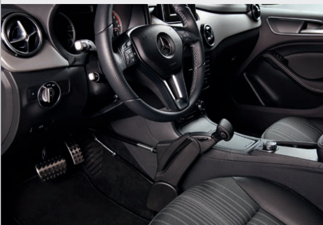
Veigel HB Kompakt Zug Druck Handbediengerät für Gas/Bremse
