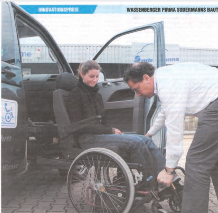
Ein neu entwickeltes Lifsystem macht es möglich, dass Rollstuhlfahrer ohne Umheben auf den Beifahrer- oder Fahrersitz eines umgerüsteten Wagens gelangen können. Foto: Harald Felber
