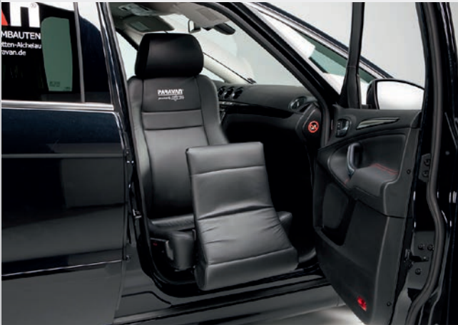
Dreh- und Schwenksitz mit integrierter Aufstehhilfe
