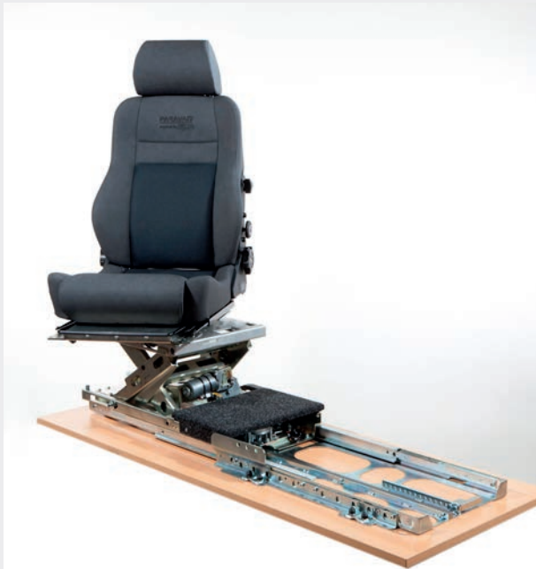
6-Wege Transferkonsole, ohne Schienen am Boden
