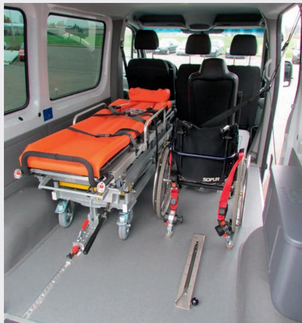
Fahrtrage zum Liegendtransport optional mit Einzelsitz, Rollstuhlsplatz, Tragestuhl
