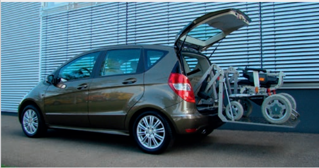
Scooterboy Verladesystem für Elektrorollstühle und Scooter
