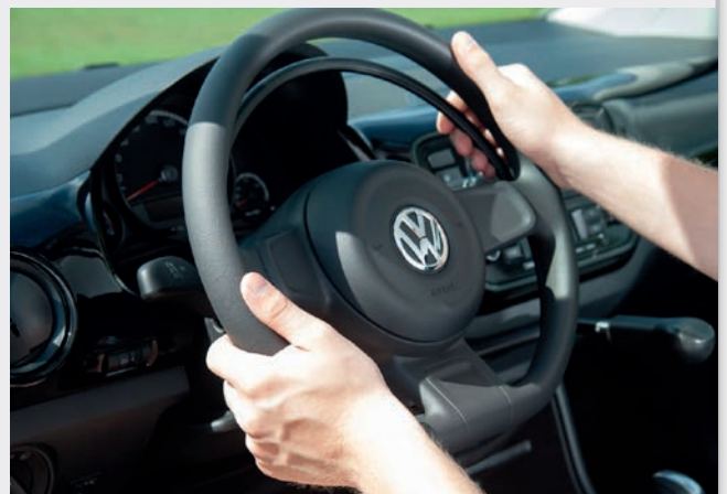
Gasring unter dem Lenkrad inkl. separatem Bremshebel
