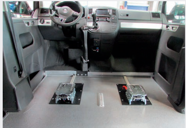
Bodenbegradigung im vorderen Bereich: Perfekt eingefasst mit geprüfter Halterung für den Autositz und Dockingstation für den Rollstuhl. *
