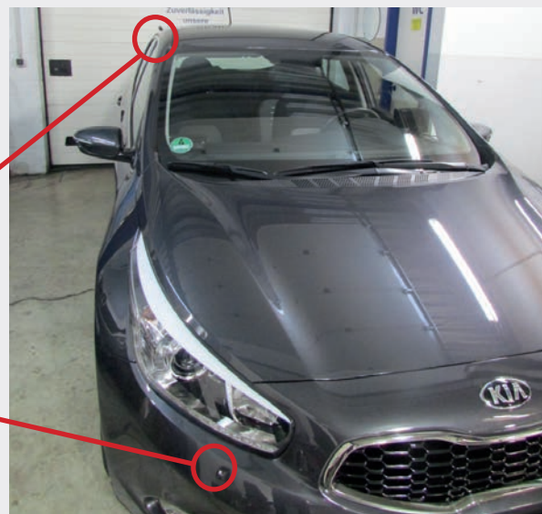
Die Kameras sind je nach Einschränkung wahlweise rechts oder links einsetzbar.
