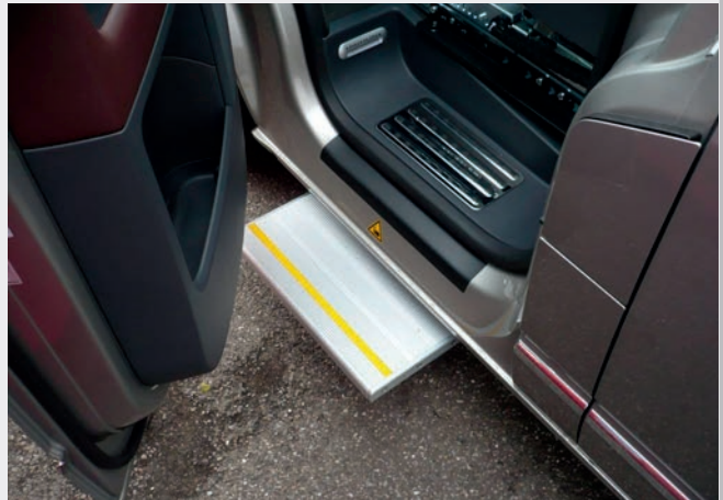
Elektrische Kassettentrittstufe, hier Fahrertüre
