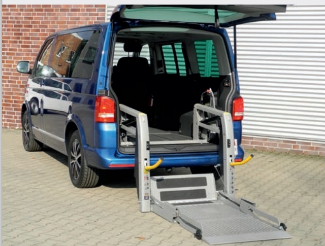
Panorama Hecklift , Rücksicht im eingeklapptem Zustand ist frei
