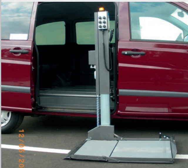
Schwinglift - während der Fahrt eingeklappt im Fahrzeug, an der Schiebetüre
