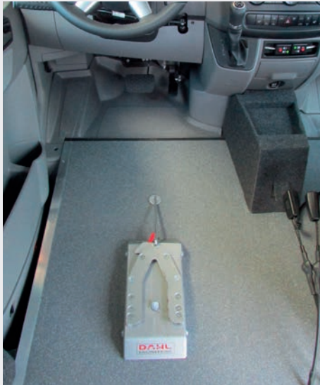
Dockingstation elektrisch entriegelbar für z. B. Aktivrollstühle
