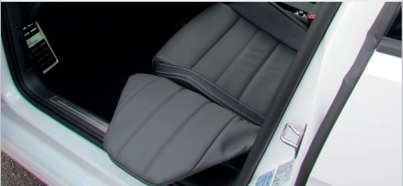
Klappbares Rutschbrett / Umsetzhilfe – auch als elektrische Aufstehhilfe möglich
