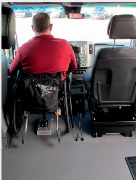
Dockingstation elektrisch im arretierten Zustand
