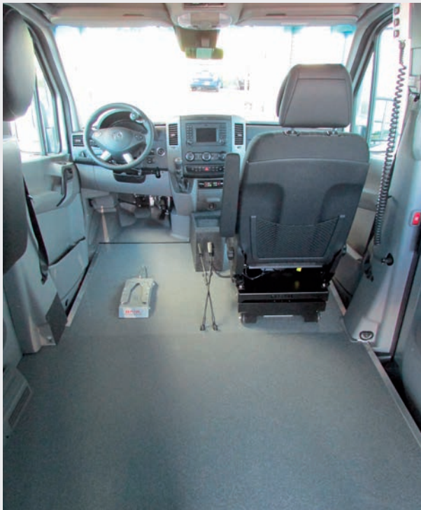
Bodenbegradigung Fahrer/ Beifahrerseite um mit dem Rollstuhl direkt bis hinter das Lenkrad fahren zu können. Wahlweise ein Rollstuhl oder ein Autositz.
