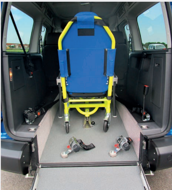
Tragestuhl inkl. fest verbauter Schiene zur Arretierung
