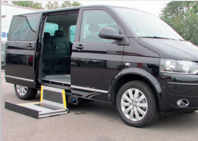
Kassettenlift K90 Activ , Plattform: 69 x 80cm, Hubkraft 200 kg
