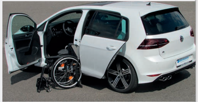
Ladeboy S2 Verladesystem für faltbare Rollstühle, für jeden PKW mit vier Türen
