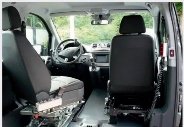
Transferkonsole für bequemes und einfaches Umsetzen im Fahrzeug: Die Konsole fährt vor/zurück, hoch/runter und dreht
