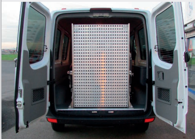
Faltbare Alu-Rampe hier im Mercedes Benz Sprinter
