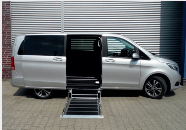
Kassettenlift K90 , Plattform: 80cm x 120cm oder 100cm, Hubkraft 300 kg
